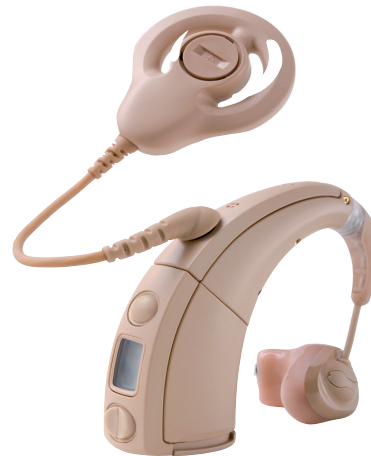
Abb. 19: Hybrid-Soundprozessor der Firma Cochlear für die kombinierte elektrisch-akustische Stimulation (Quelle: Cochlear Ltd.).
