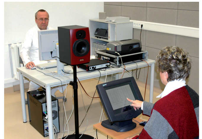
Abb. 35: Psychoakustischer Freifeldmessplatz zur Durchführung des Oldenburger Satztestes. Der Patient bestätigt die von ihm verstandenen Worte auf einem Touchscreen.
