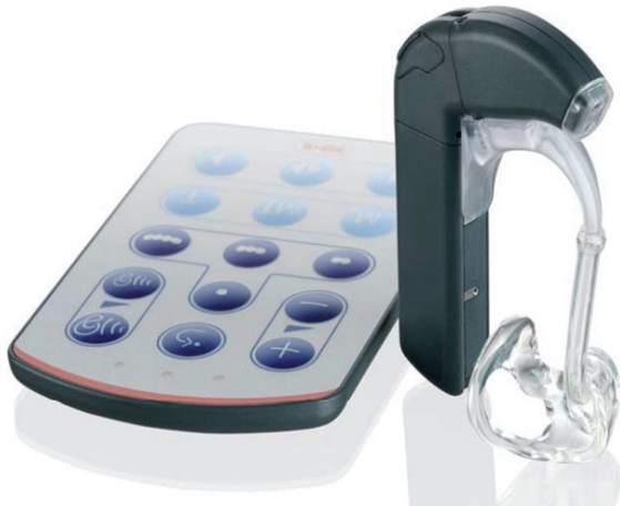
Abb. 18: DUETT2-Signalprozessor der Firma MED-EL für die kombinierte elektrisch-akustische Stimulation (Quelle: MED-EL Deutschland GmbH).
