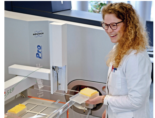
Janne Reinking, Doktorandin im Projekt B16, vergleicht unterschiedliche T-Zell Populationen mittels Massenspektrometrie. | Foto: Prof. Dr. rer. nat. Lothar Jänsch
